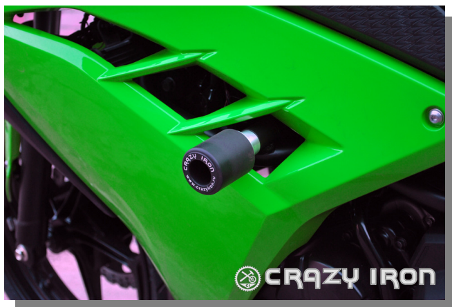
Левая сторона с установленным слайдером
